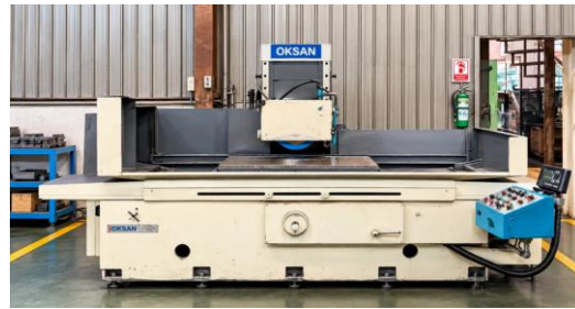
연삭기 · Grinding 02 CHINE | APSG-50100AHR
