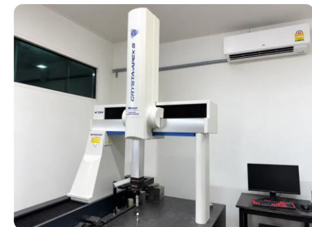
CMM-01 3차원 측정기 MITUTOYO CRYSTA-Apex S
