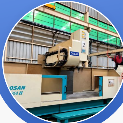
DOOSAN VM84 2150x850x950mm RPM 8,000 Pull stud 90° BT 50
